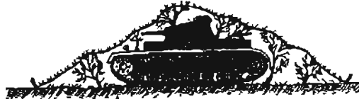
Bild 27. Formzerstreuung des Panzerkampfwagens durch Tarnnetz
